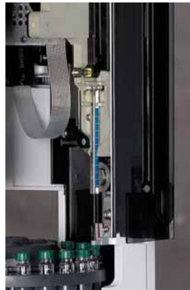
7693A ALS に搭載された ブルーラインオートサンブラシリンジ、 G4513-80204
