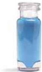
クリンプバイアル、高回収率、5182-3454
