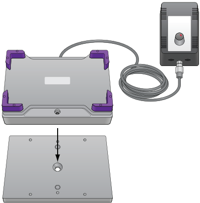
Agilent オービタルシェーカーステーション およびコントロールユニットとマウントプレート
