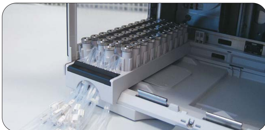
図2 フラクションコレクタに設置されたファネルトレイ
