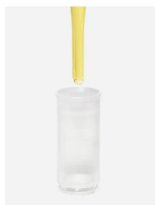
1. 充填 ピペットでサンプルを 充填ラインまで入れます。
