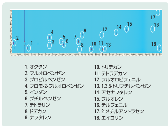
図 2. 炭化水素テストサンプルの分離結果を検証できる 2D GC 表示
