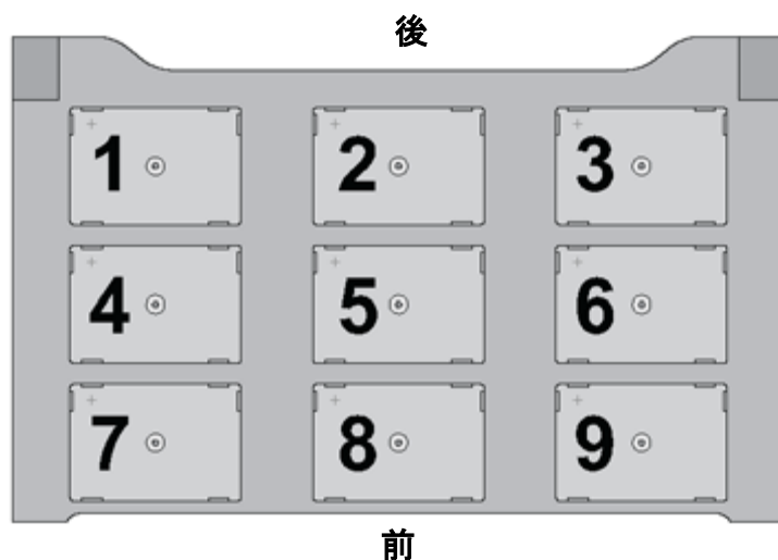
図 1 Bravo プラットフォームデッキ
