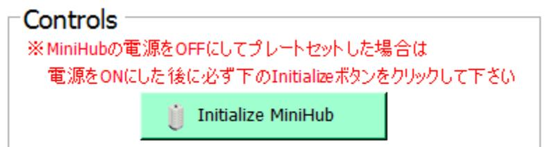
ただし、この機能は、上記の Initialize MiniHub のボタンがついた Form でのみ使用可能です。このボタンがついていない Form を使用している場合、MiniHub の電源を切って MiniHub を手で回転させないようにしてください。**MiniHub の電源を OFF にして位置を変えた場合、必ず、MiniHub のイニシャライズ操作が必要です。イニシャライズを行わずに動作を進めると、エラーが発生します。**
