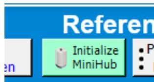
ただし、この機能は、上記の Initialize MiniHub のボタンがついた Form でのみ使用可能です。このボタンがついていない Form を使用している場合、MiniHub の電源を切って MiniHub を手で回転させないようにしてください。MiniHub の電源を OFF にして位置を変えた場合、必ず、MiniHub のイニシャライズ操作が必要です。イニシャライズを行わずに動作を進めると、エラーが発生します。
