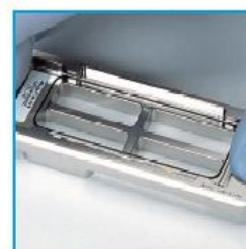
4. ハイブリダイゼーション溶液をガスケットスライド上にアプライします。アレイスライドのバーコード番号およびアプライしたサンプル位置を記録しておきます。
