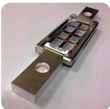
1. ピンセットを使ってガスケットスライドのプラスチックカバーの端をつまみ、ゆっくりとはがします。ガスケットスライドをパッケージから取り出します。この時、スライドの縁以外には触れないようにしてください。必ずパウダーフリーの手袋を着用してください。
