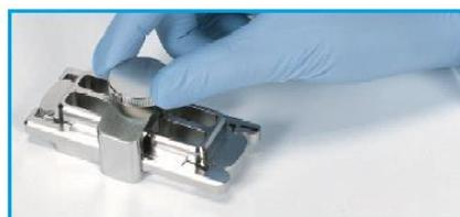
9. 組み立て終了後、チャンバを垂直方向にして 2,3 回、回転させて、ハイブリ溶液がスライドガasketの全面に行き渡るようにします。次に、チャンバ内の泡が自由に動くことができるか確認してください。ハイブリ溶液が行き渡っていない部分や、固定している泡によりハイブリむらが起きる場合があるので、泡が動かない場合にはチャンバを手で軽く振り、泡を移動させます。
