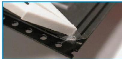
2. チャンバベースの上に、ガスケットスライドを“Agilent”の文字あるいはバーコード番号が書かれている面を上にして載せます。ガスケットスライドは、ハイブリダイゼーション溶液を介して直接アレイに触れますので、ほこり等がつかないようにすばやくセットしてください。
