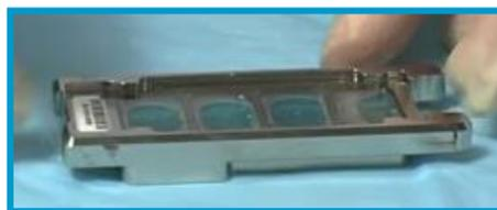
**注意** 1スライドに複数のアレイが搭載されているタイプで、チャンバカバーをセットする前、“サンプル溶液が接しているアレイ”と“接していないアレイ”があるように見える場合がありますが、問題ありません。アレイスライドを乗せた後は、位置の微調整などは行わず、すぐチャンバカバーを乗せて下さい。
