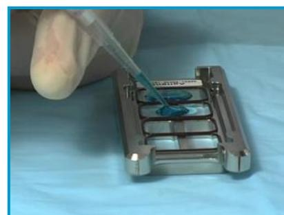
6. アレイ面(Agilent と書かれているバーコード面) を下にして(数字が書かれている方のバーコード面は上に)、マイクロアレイスライドをチャンバベースにセットされているガスケットスライド上に載せます。このとき、アレイスライドの縁またはバーコードシール部分を持つようにしてください。マイクロアレイスライドを**水平に保ったまま**ガスケットスライドにのせます。
