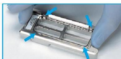
3. ガスケットスライドがしっかりとチャンバベースにセットされているか確認し、正しくされていない場合は、再度セットし直してください。
