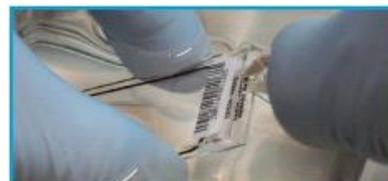
7. 残りのチャンバも同様に解体して、すべてのスライドをラックに差し込みます。一度に洗浄するスライドは **8 枚以下** にするようにしてください。
