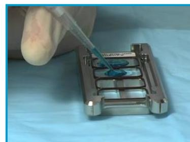
6. アレイ面(Agilent と書かれているバーコード面) を下にして(数字が書かれている方のバーコード面は上に)、マイクロアレイスライドをチャンバベースにセットされているガスケットスライド上に載せます。このとき、アレイスライドの縁またはバーコードシール部分を持つようにしてください。**マイクロアレイスライドを水平に保ったままガスケットスライドにのせます。**
