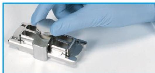
9. 組み立て終了後、チャンバを垂直方向にして 2,3 回、回転させて、ハイブリ溶液がスライドガasketの全面に行き渡るようにします。次に、チャンバ内の泡が自由に動くことができるか確認してください。ハイブリ溶液が行き渡っていない部分や、固定している泡により、ハイブリむらが起きる場合がありますので、泡が動かない場合には、チャンバを手にもって振ることで、泡を移動させます。
