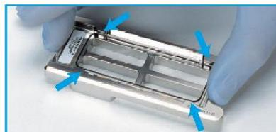
3. ガスケットスライドがしっかりとチャンバベースにセットされているか確認し、正しくされていない場合は、再度セットし直してください。
