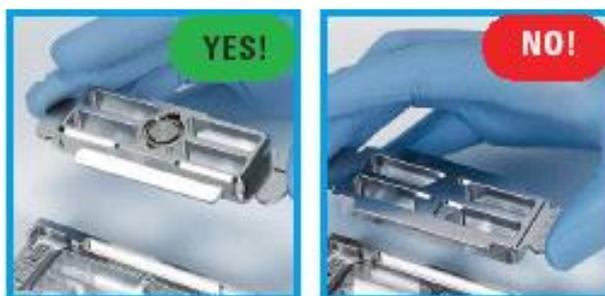
8. クランプアセンブリを、チャンバベースの丸くなっているコーナー側から差し込み、完全にストップする位置まで移動させます。ストップする位置は、ちょうどチャンバの中央部になります。
