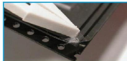
③ ガスケットスライドを、ガスケットのラベルシールが貼られている面(ガスケットが搭載されている面)を上にして、チャンバベースの上に載せます。ガスケットスライドは、ハイブリダイゼーション溶液を介して直接アレイに触れますので、ほこり等がつかないようにすばやくセットしてください。
