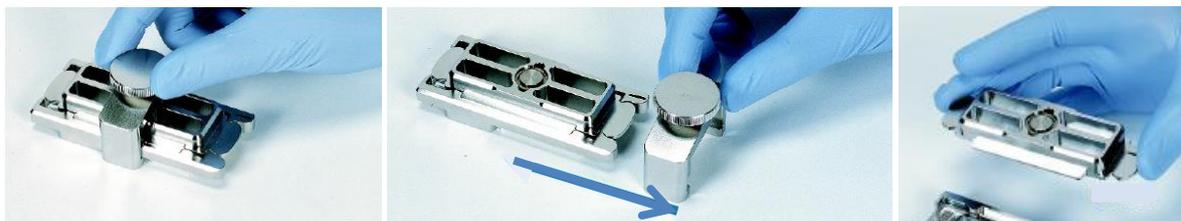
②ピンセットを使ってガスケットスライドのプラスチックカバーの端をつまみ、ゆっくりとはがします。ガスケットスライドをパッケージから取り出します。この時、スライドの縁以外には触れないようにしてください。必ずパウダーフリーの手袋を着用してください。
