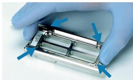
ガスケットスライドがしっかりとチャンバベースにセットされているか確認し、正しくされていない場合は、再度セットし直してください。
