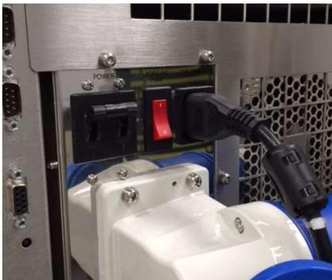
ICPMS 前面の主電源スイッチをオンにします。
