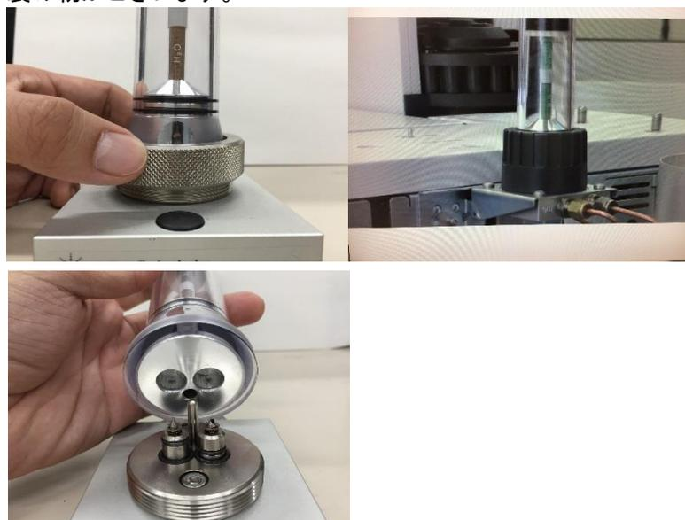
※必要によって、ベースのバルブ O リングを付属の新しい物と交換します。
