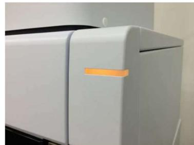
3. ICP Expert7 を起動し、[装置] をクリックして、ポリクロメーターの温度が  $35\pm 2^{\circ}\text{C}$  になるのを待ちます。数時間かかります。
