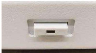
2. 電源スイッチの LED が消灯後、電源ブレーカーをオフにします。電源スイッチは消灯後も 10 秒に 1 回、一瞬緑色に光りますがこれは正常です。
