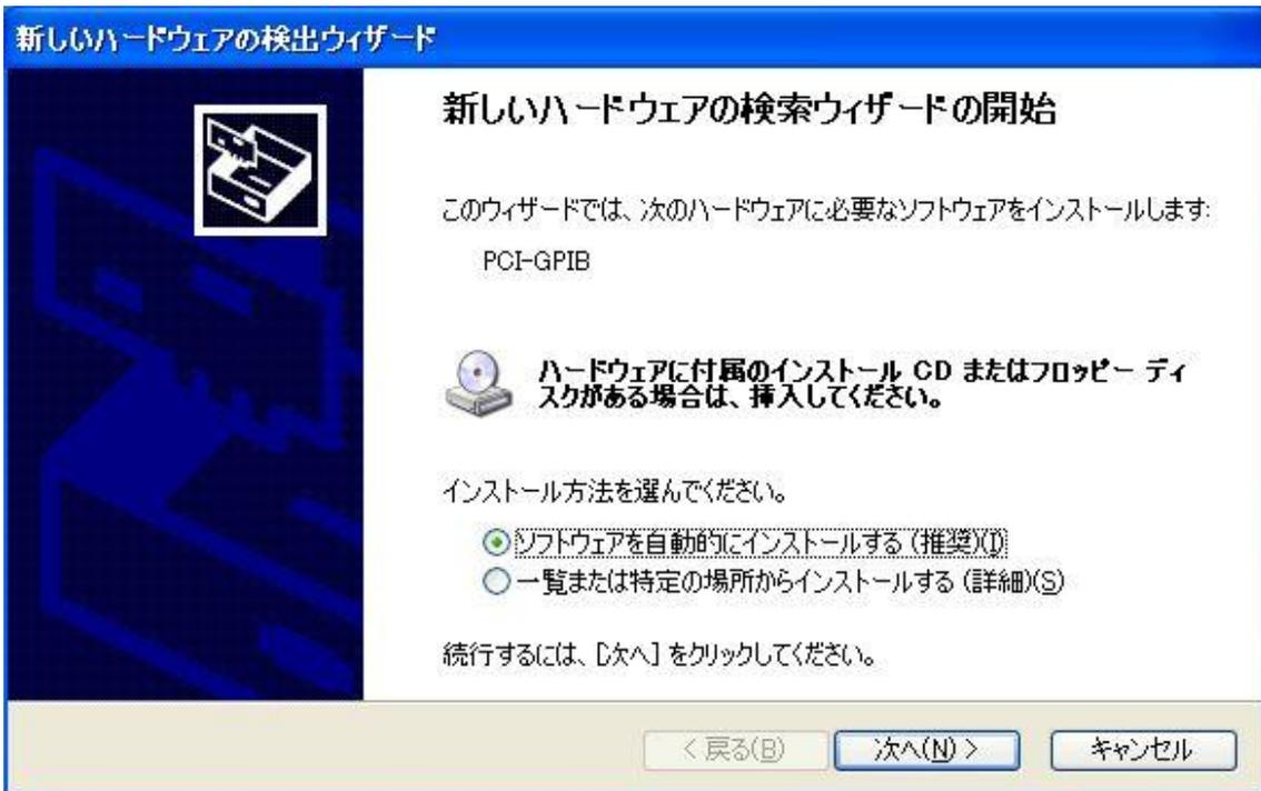
GPIB ボードの作業後にコンピュータを起動すると、「新しいハードウェアの検索ウィザードの開始」が始まることがあります。
