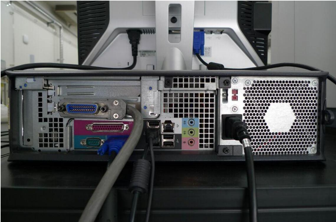
電源がオフの状態、コンピュータ背面に取り付けられているケーブルを全て外します。
