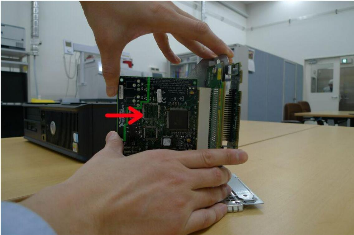
GPIB ボードがしっかりと挿入されていない場合は、矢印方向に押し込みます。
