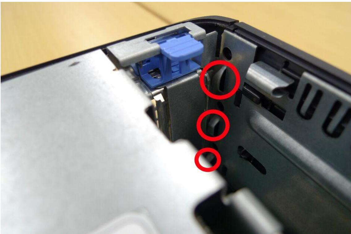
○印の部分のレールに沿うように、ライザーケージをコンピュータに戻します。
