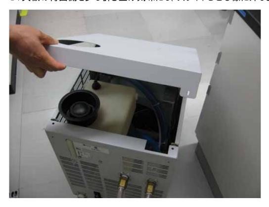
3.側面の板を外します。引き上げると外れます。
