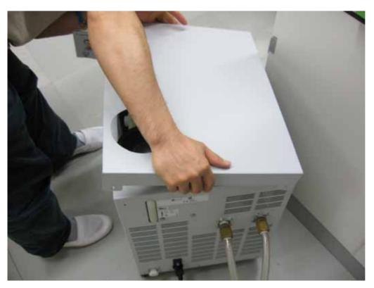
6.背面の固定ネジ2本を締めます。
