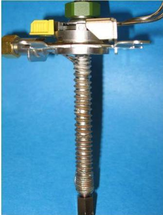
＜要旨＞ マルチモード注入口(MMI)ではコールドスプリットレス (CSL) モード、溶媒排出モード (大量注入 : LVI) を使用することで、簡単に高マトリックス中の微量成分の高感度分析が達成できます。5975CTAD シングル四重極においてはマトリックスが目的成分を妨害するため、5 $\mu$ l の CSL を用いました。一方で、7000B トリプル四重極においては MRM モードで選択性を確保できるため、25 $\mu$ l の LVI を適用することが可能です。これらの注入法により通常のスプリットレス分析と比較し 2-10 倍以上の高感度化が可能でした。
