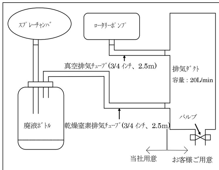
図 4-1 排気ダクトへの配管の概略図
