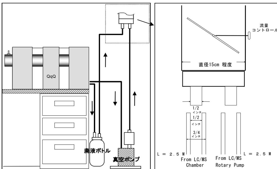
図 4-2 排気ダクトへの配管
