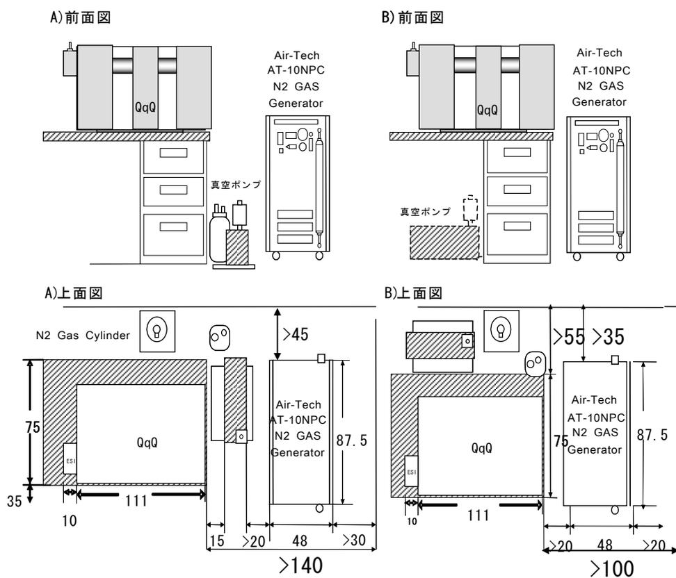
図-3-1 窒素ガスジェネレータ設置例
