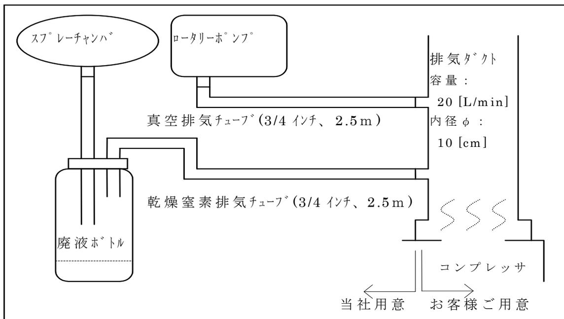
図-4-5 排気ダクトへの配管の概略図
