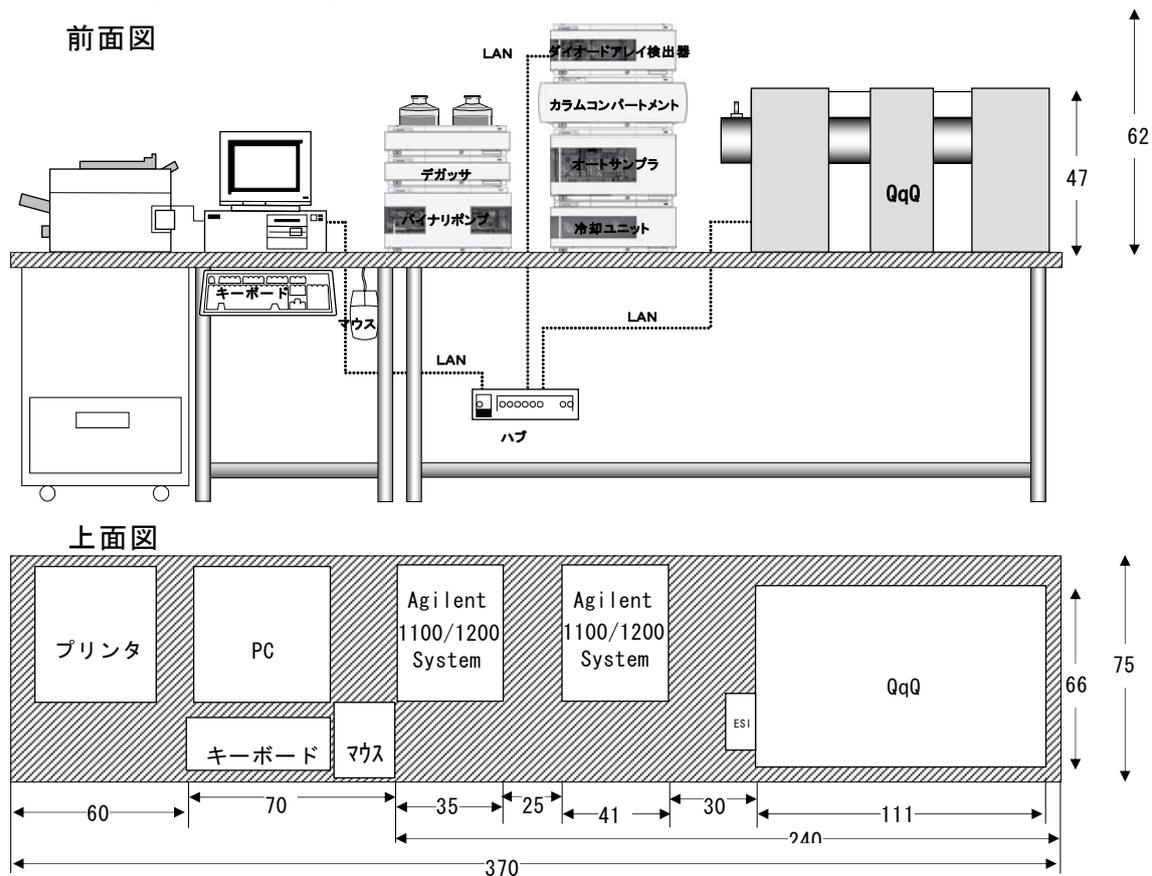
図 2-3 冷却ALSを含んだ2段積のシステム設置例
