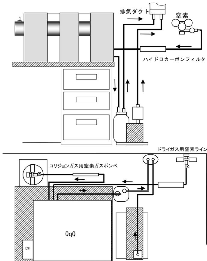
図-3-3 窒素ガス配管例
