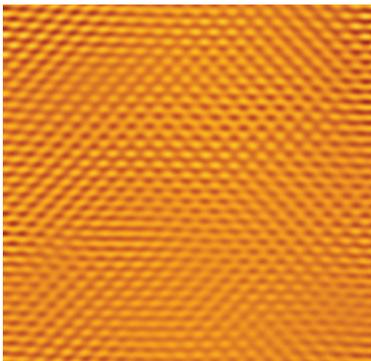
図5. 200°C(FFTフィルター処理後)におけるマイカ原子のAFMイメージ。16nm x 16nm視野
