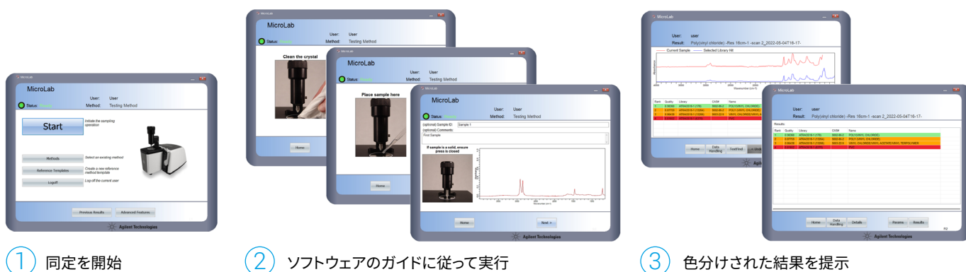
図 2. Agilent MicroLab ソフトウェアと Agilent Cary 630 FTIR を使用した 3 つの簡単なステップにより、プラスチックの同定を簡素化することができます。また、画像駆動型のソフトウェアは、トレーニングの必要性を減らし、ユーザーによるエラーのリスクを最小限に抑えます。
