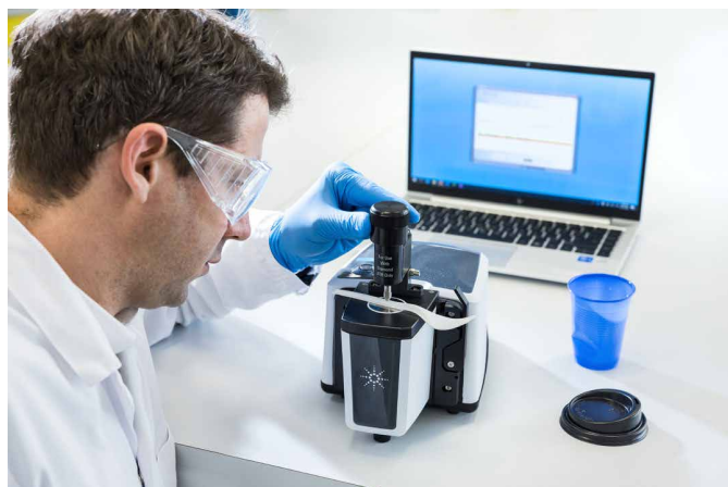
図 3. Agilent Cary 630 FTIR (ATR サンプリングモジュールを装着) を用いたプラスチックフィルムとプラスチック廃棄物の分析。
