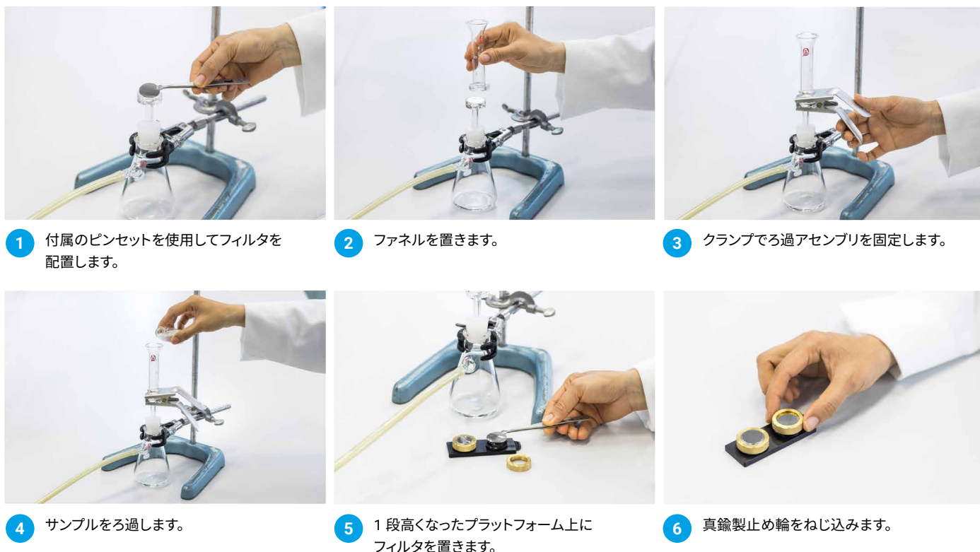
図 3. アルミニウムコーティングフィルタ上でマイクロプラスチックサンプルを調製するためのサンプルろ過装置と手順の概要。Agilent 8700 LDIR ケミカルイメージングシステムによる分析が可能です。
