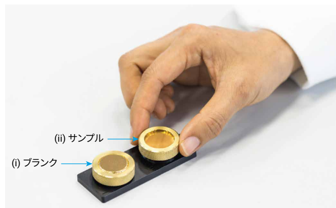
図 4. Agilent 8700 LDIR フィルタホルダは、ブランクとサンプルのシーケンス測定のためにポジションを 2 つ備えており、マイクロプラスチック分析の堅牢な QC が可能になります。
