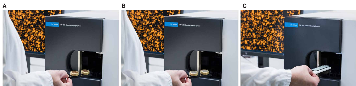
図 2. ホルダ上の (A) 金および (B) アルミニウムコーティングフィルタ、(C) low-e IR 反射スライド。サンプルはいずれの基材上でも調製することができ、Agilent 8700 LDIR ケミカルイメージングシステムを用いた直接分析が可能です。
