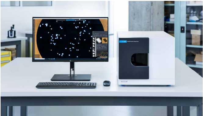
図 1. Agilent 8700 LDIR ケミカルイメージングシステムは、飲料水中のマイクロプラスチックのルーチン分析を高速で実行することができ、サンプルに含まれる粒子の数、サイズ、化学組成などのデータを提供します。
