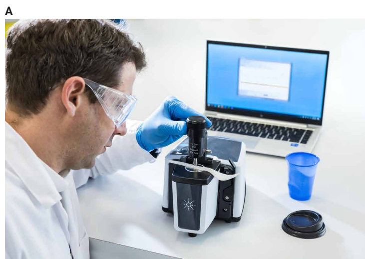
図 6. (A) ダイヤモンド ATR モジュールを装着した Agilent Cary 630 FTIR 分光光度計。(B) プラスチック断片 (赤のトレース) とライブラリヒット (青のトレース) の Cary 630 FTIR 定性分析スペクトルデータの例。この表は、各サンプルのヒットクオリティ、使用ライブラリ、ヒット名を示しています。HQI スコアに基づいて結果を色分けすることにより、信頼レベルを定義することができます。これにより、ユーザーは結果を解釈しやすくなり、エラーにつながる可能性のある見落としを減らすことができます。
