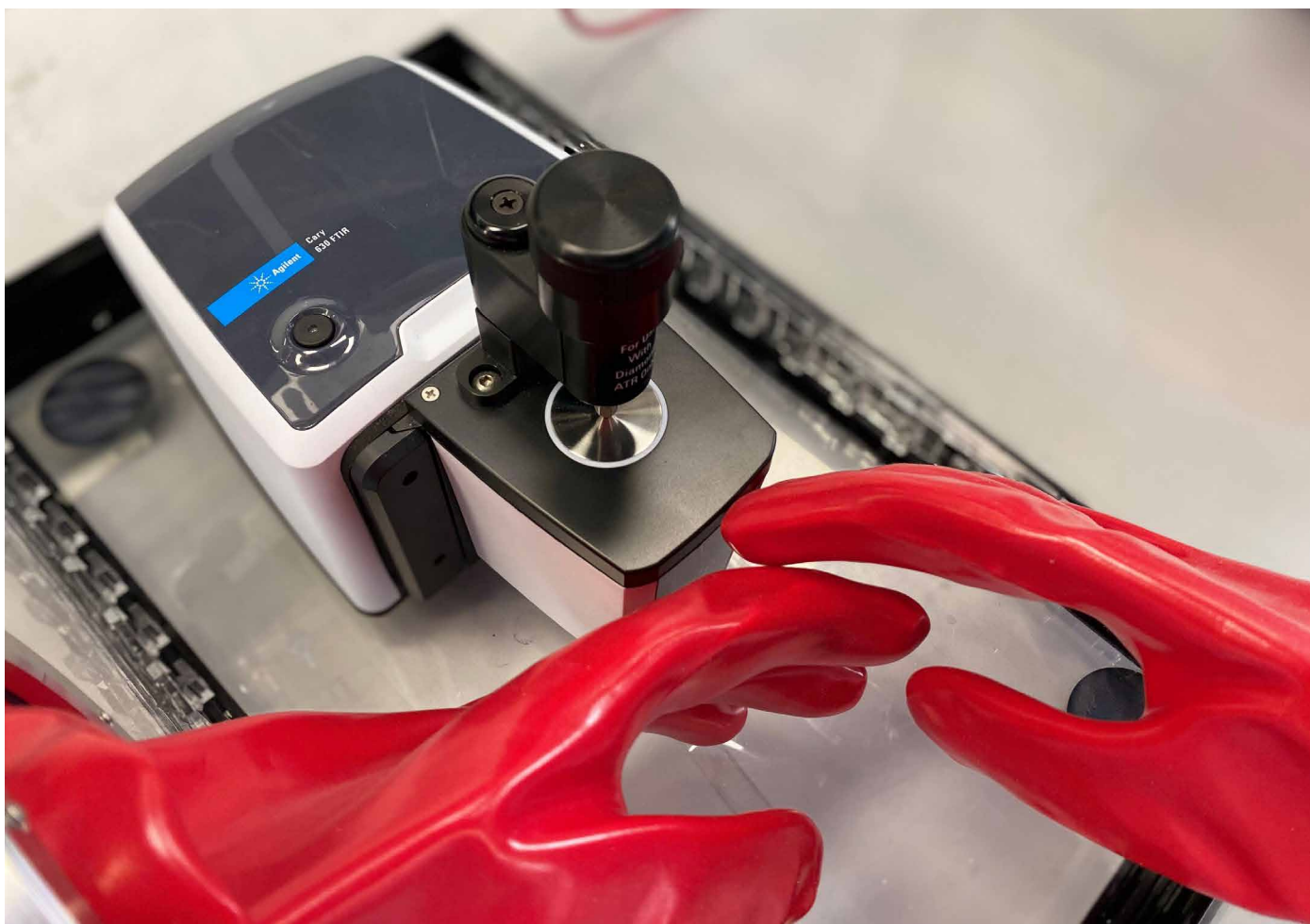
図 4. 水分や酸素の濃度を管理可能なグローブボックス内部の Agilent Cary 630 FTIR 分光光度計。LIB 研究アプリケーションに最適な設定です。
