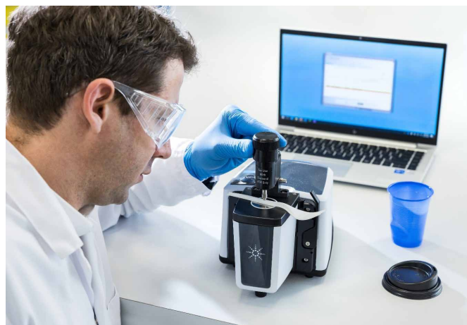
図 6. Agilent Cary 630 FTIR 分光光度計。より大きなプラスチック片の発生源を特定するのに有用です。
