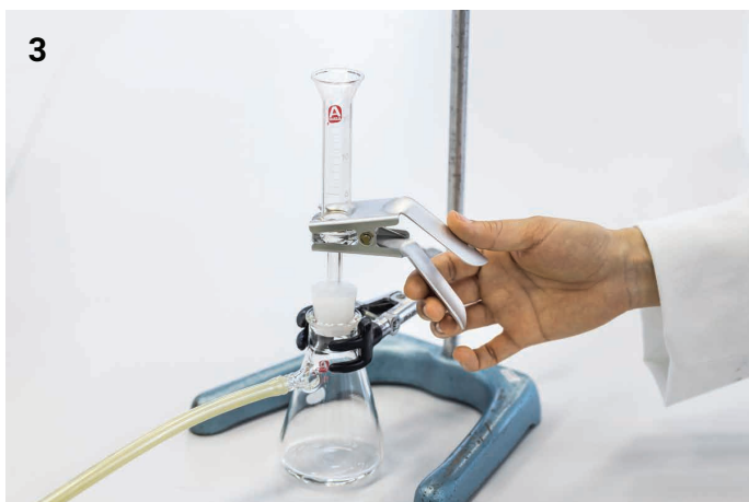
図 3. LDIR オンフィルタ分析のサンプル前処理のためのサンプルろ過装置と手順
