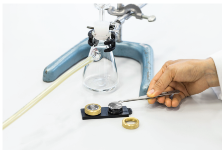
5 高い位置のプラットフォームの上にフィルタを置きます
