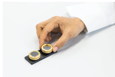
6 真鍮の止め輪で固定します。
