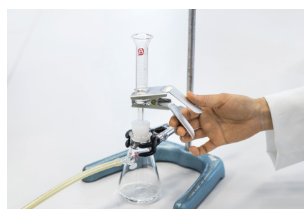
3 ろ過アセンブリをクランプで固定します
