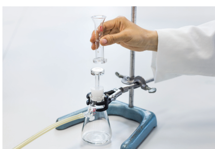
2 漏斗を置きます
