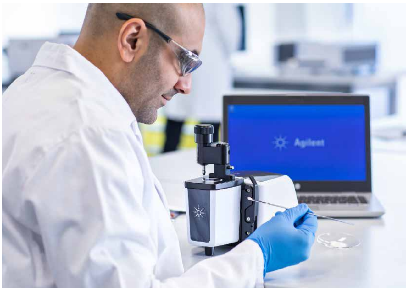
図 1. ダイアモンド ATR モジュールを備えた Agilent Cary 630 FTIR 分光光度計は、作物サンプル中の栄養素を高速かつ容易に分析するための最適なツールです。
