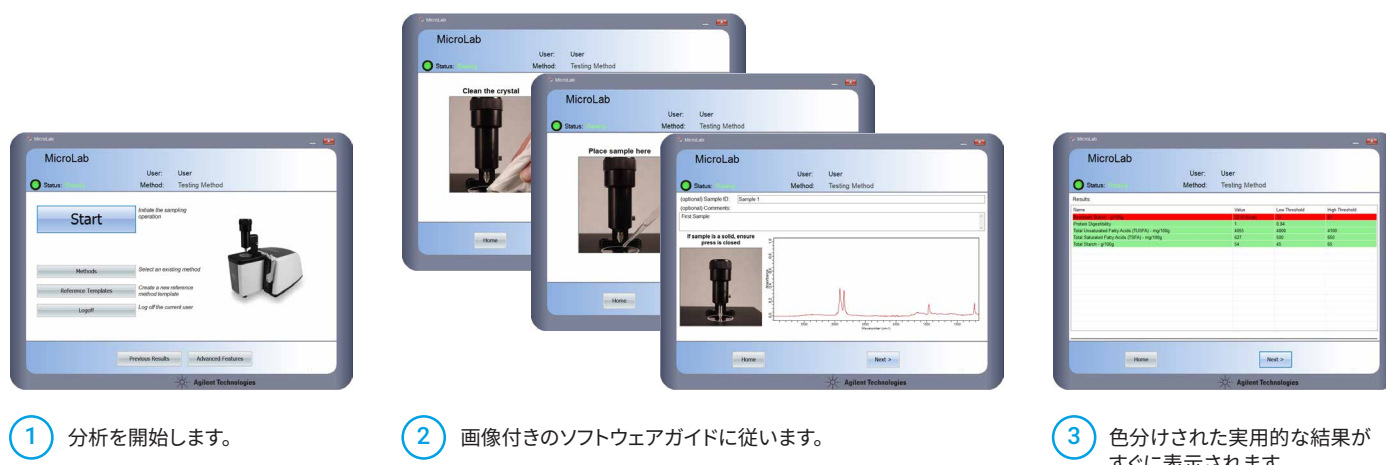
図 4. Agilent MicroLab ソフトウェアと Agilent FTIR 分光光度計を使用した 3 つのシンプルなステップにより、分析を簡単に実施できるため、トレーニングが不要になります。
