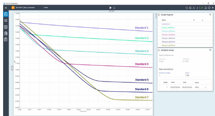
図 3. Cary 3500 UV-Vis システムで同時に測定した 7 つの標準溶液の時間ベースの吸光度測定
