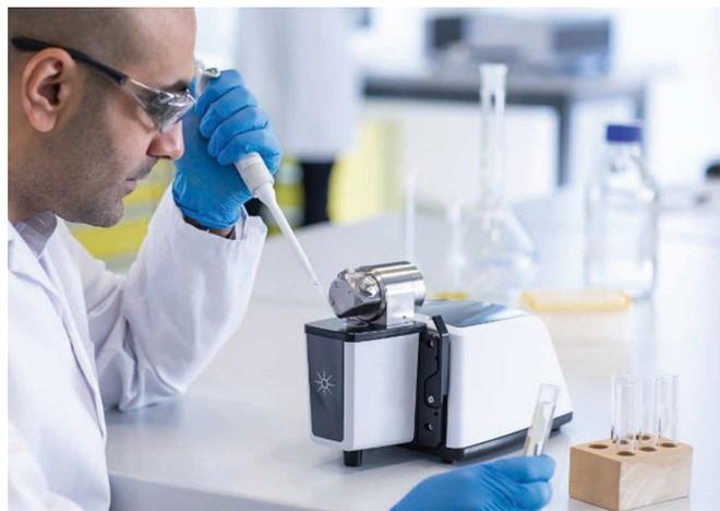
図 2. 液体サンプルは、Agilent Cary 630 FTIR 分光光度計に装着された DialPath モジュールのサンプルウィンドウに配置します。
