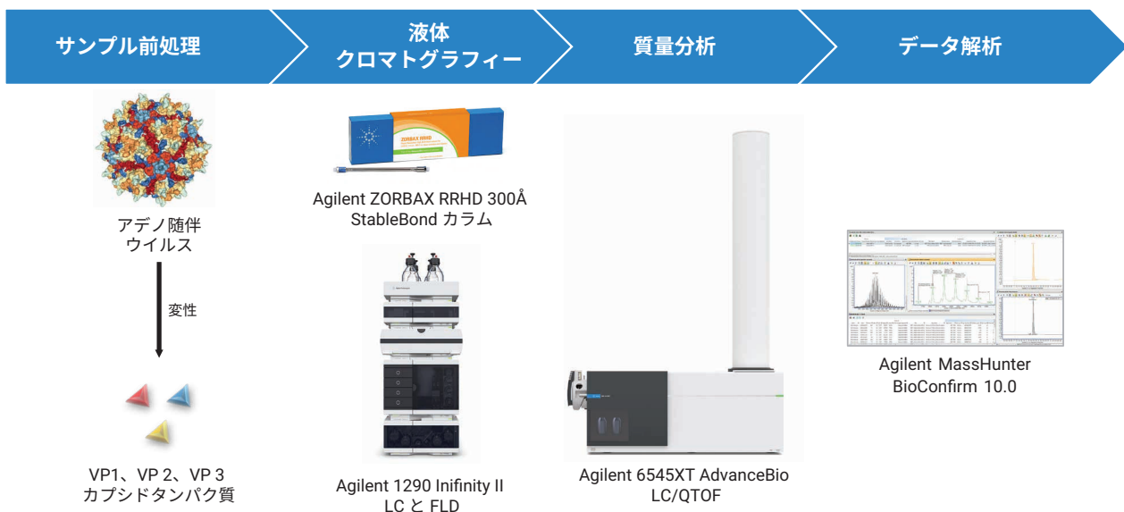
図 1. このアプリケーションノートで使用された機器と消耗品
