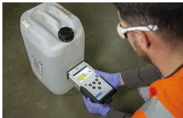
図 2. Vaya を用いた不透明なプラスチック製カーボイ容器内の酢酸の同定検証
