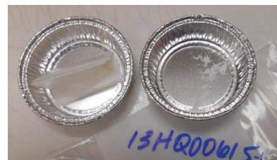
図 4A. 粉末コカインの押収サンプル。これを、ポケットチッププローブで採取しました。採取後、プローブをきれいな葉包紙に、ポケットチップを下にして置き、プローブをメタノールで 2 回すすぎました。プローブが乾いてから、あらかじめ水洗いし、実験用の化学布巾で水気を拭き取ったホルダーに挿入しました。
