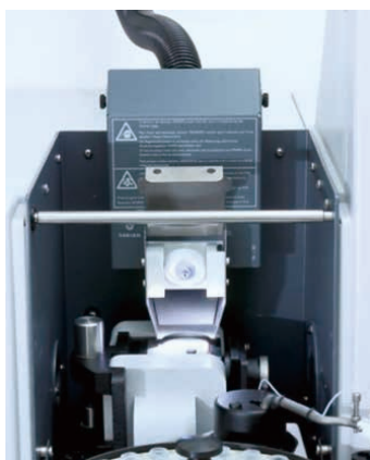
図 1. Agilent GTA 120 グラファイトチューブアトマイザ用オプションのヒュームエクストラクションシステム
