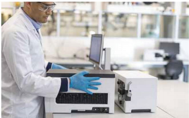
図 1. Cary 3500 マルチセル分光光度計は、エンジン（右側）とマルチセルモジュール（左側）の 2 つの部分で構成されています。この 2 つの部分と接続して分光光度計全体が構成されます。
