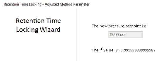
図 7. リテンションタイムロックの圧力キャリブレーションの結果
