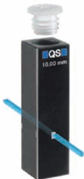
図 1. Cary 3500 UV-Vis は幅 1.5 mm 未満の高集光ビームを利用できます。ビームサイズが小さいため、この図のような開口部が小さいキューベットにも最適です。
