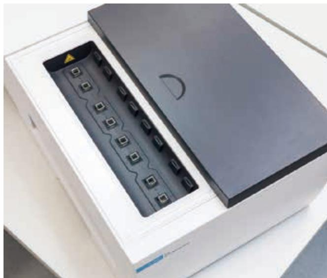
図 1. Cary 3500 マルチゾーン UV-Vis 分光光度計のサンプルコンパートメントには内蔵マルチセルホルダがあります。各サンプル/リファレンスペアを異なる温度に維持できます。
