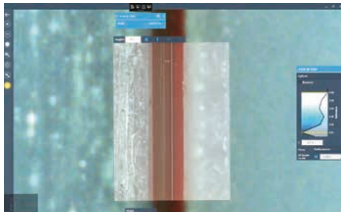
図 1. サンプルホルダの保持用プラスチック材料 (白) に挟まれたラミネート (赤) の高解像度可視イメージ
