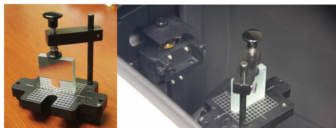
図 2. (左) 1 mm あたりの溝数が 300 本の格子をキューブビームスプリッタのサンプルホルダに取り付けた状態。(右) Cary 7000 UMS のサンプルステージにセットされたサンプルホルダ。検出器は 10^\circ に保持。
