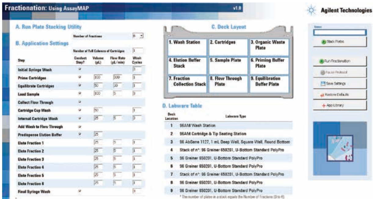
図 2. 分画アプリケーションのユーザーインターフェースのデフォルト設定
