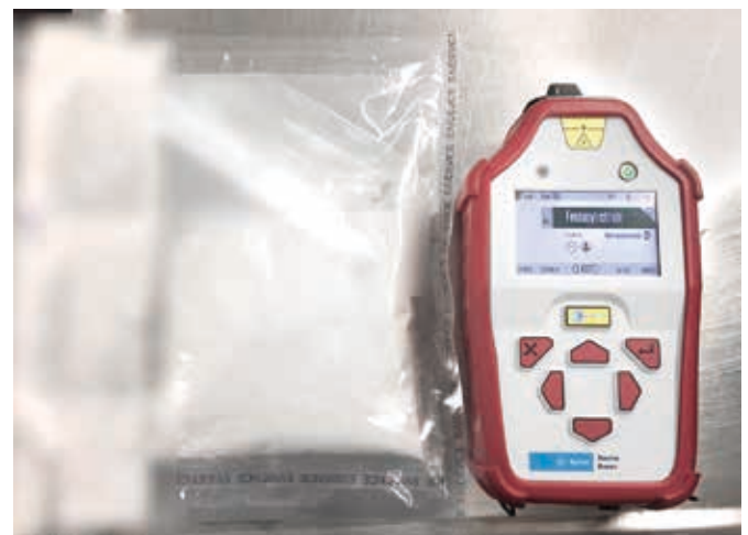
図 3. 複数のプラスチック層ごしのフェンタニルのスキャン
