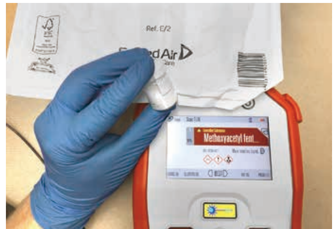
図 2. 白い紙、茶色の紙、緩衝材、ガラスごしの、押収したメトキシアセチルフェンタニルのサンプルのスキャン
