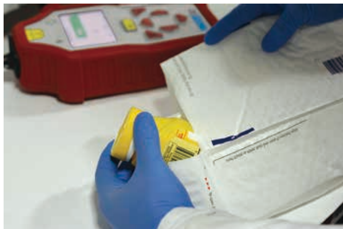
図 1. Agilent Resolve システムは、サンプルに関する予備知識がなくてもパッケージの複数の不透明層ごしにスキャンできる独自機能を搭載。この例は、不透明なプラスチックと郵便袋に入った錠剤の試験。
