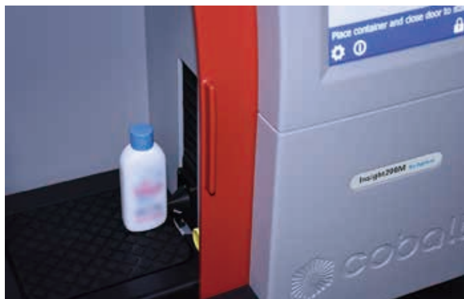
図 3. Insight200M システムでの 100 mL 容器の検査
