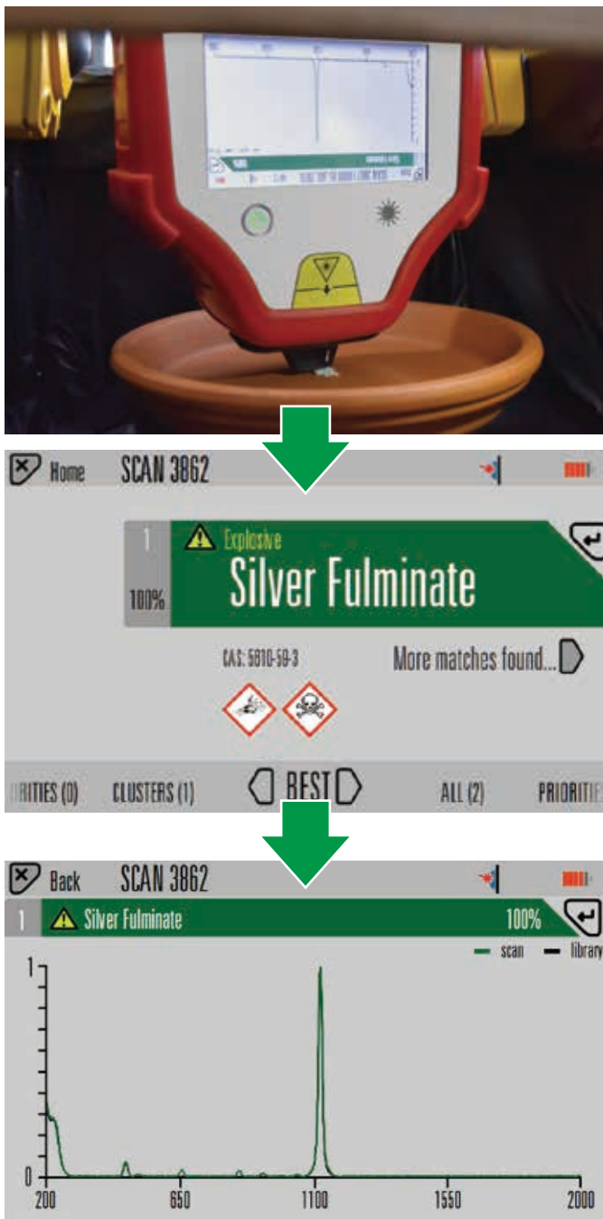
図3. 範囲試験の例: Agilent Resolve システムによる雷酸銀粉末のピンポイント同定
