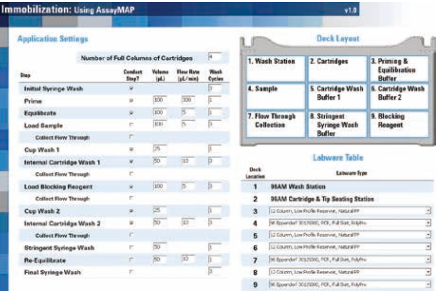
図 3. Agilent AssayMAP Bravo のユーザーインターフェース。抗体アフィニティカートリッジの生成に使用する AssayMAP Bravo 上の Immobilization (固定化) アプリケーションの設定画面を示します。
