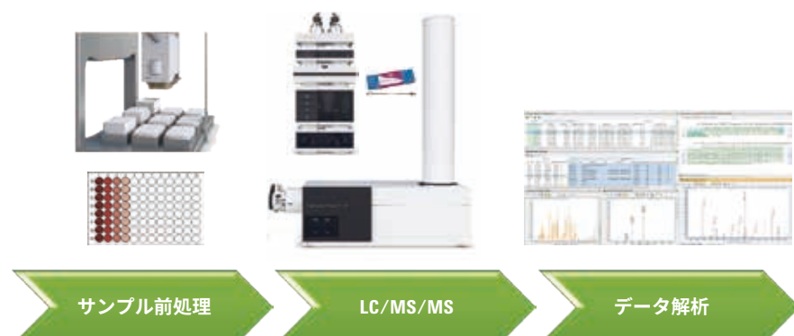
図 1. mAb のペプチドマッピングのための統合ワークフロー。Agilent AssayMAP Bravo Platform による自動サンプル前処理、Agilent 6550 Q-TOF LC/MS/MS による分析、および Agilent BioConfirm B.08 による解析で構成されています。
