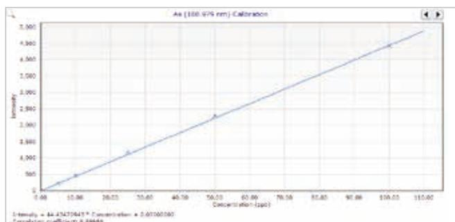
図 3. 5 ~ 100 µg/L の範囲の濃度で優れた直線性を示す As 188.979 nm の検量線 (機器の分析範囲の広さを示している)。
