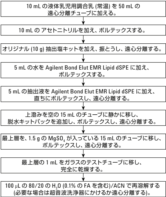
図 1. Agilent Bond Elut EMR Lipid クリーンアップと \text{MgSO}_4 を使用した強化された脱水処理を用いた、液体乳児用調合乳中のアフラトキシンのサンプル前処理プロトコル。
