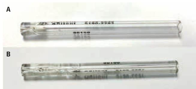
図 4. EMR Lipid クリーンアップ後に強化された脱水処理を用いて調整したアボカドサンプルを 100 回注入した後の代表的な GC 注入口ライナの外觀。A) Agilent ウルトライナートシングルテーパープリットレスライナ、ウール入り、B) Agilent UI ディンプルライナ。
