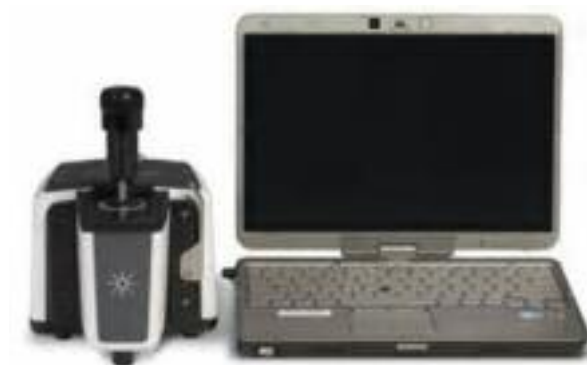
図 1 シリアル中の糖の測定には、Agilent Cary 630 FTIR 分光光度計にダイヤモンド ATR サンプルインタフェースを装着したシステムを使用しました。
