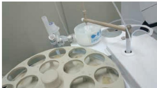
図 1. Agilent I-AS オートサンプラに適合するオルガノ社製オーバーフロー洗浄ポートキットの写真
