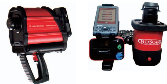
図 2. 1 回反射ダイヤモンド ATR センサーを備えた Agilent 4100 Exoscan (左) または Flexscan (右) では、1 % までの総フタル酸エステルを測定できます。
