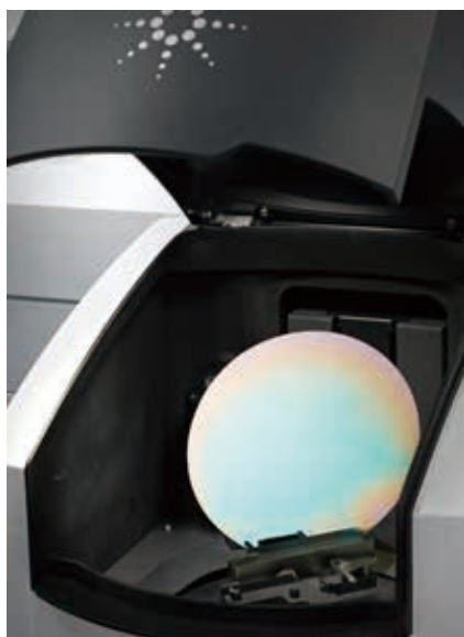
図 1. Agilent Cary 7000 UMS の測定チャンバーに直径 200 mm のシリコンウエハサンプルを取り付けた様子
